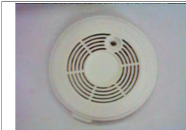
Detector Iónico de Humo Autónomo SICA
