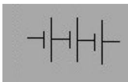
Batería de pilas
