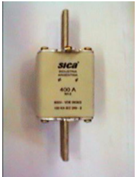
Cartucho fusible de alto poder de ruptura tipo NH tamaños 1 y 2 hasta 500 V. según normas DIN 636 o IEC 269
