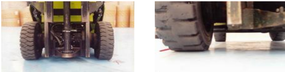
Figura 5.3-2 Gráfica de la separación de ruedas en el eje cargado e ilustración del área de las llantas en contacto directo con el piso (área de contacto).
