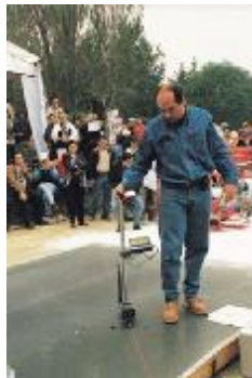
7.1-13 Medición de planicidad y nivelación mediante el Dipstick.
